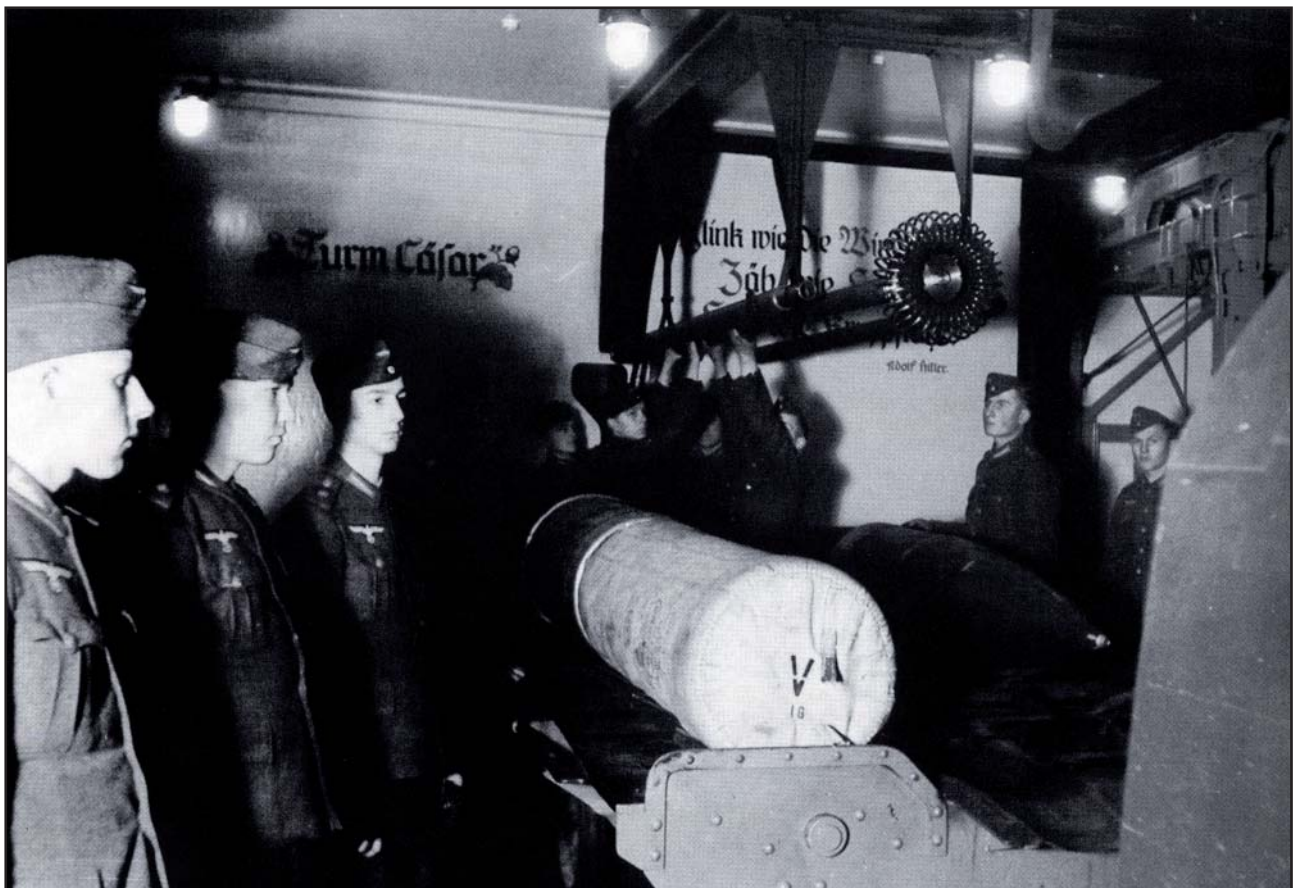
Fig. 34 : Chargement de la pièce de 406mm de la tourelle Cäsar (batterie Lindemann de Sangatte) : on distingue la façon dont était placée la charge propulsive devant la douille.
