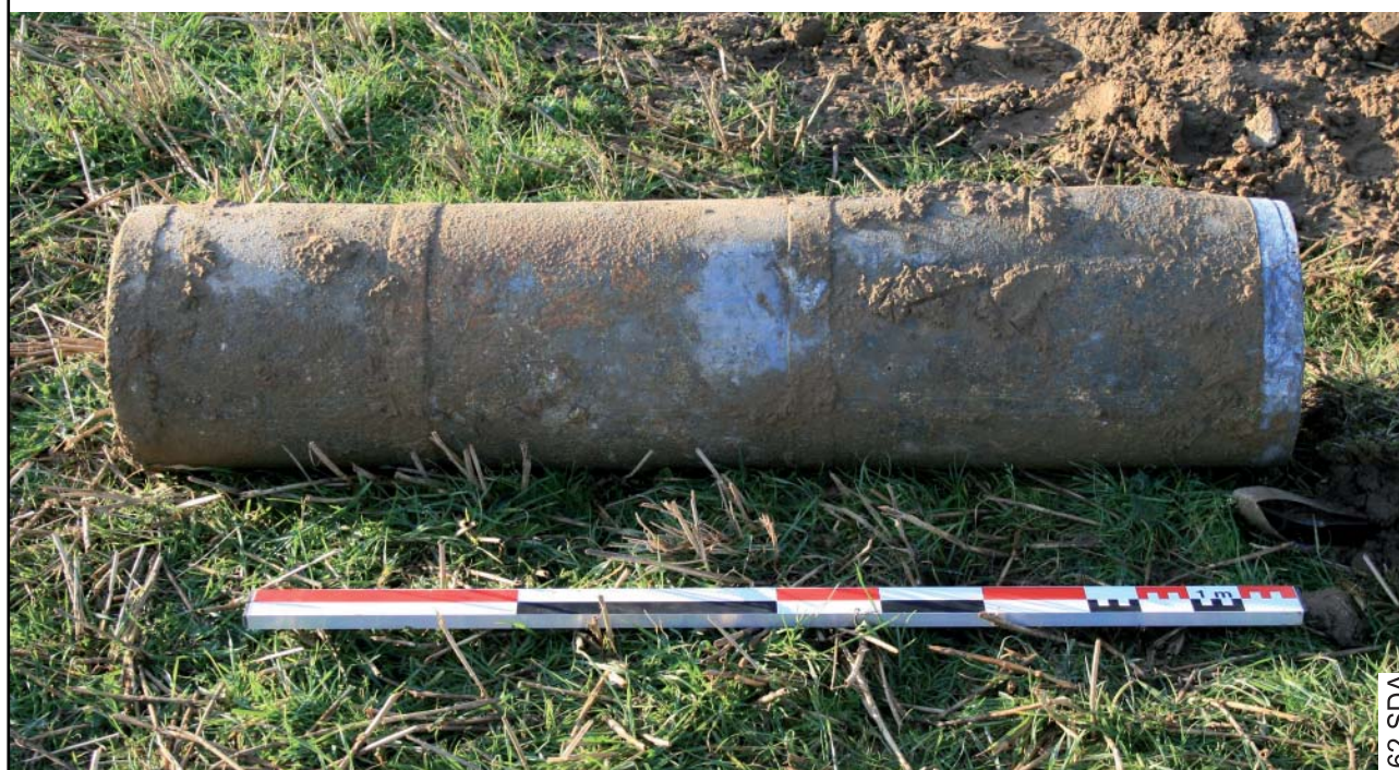
La protection en alliage cuivreux de la charge propulsive.
