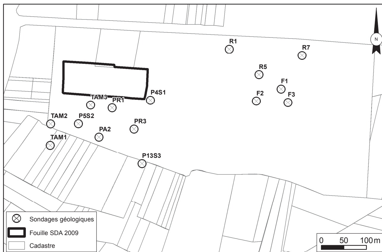
Fig. 10: Harnes, La Motte du Bois, plan de localisation des sondages géotechniques (S.E.F. 2009) et des sondages de la BSS (BRGM-Infoterre 2009) par rapport à la fouille.
